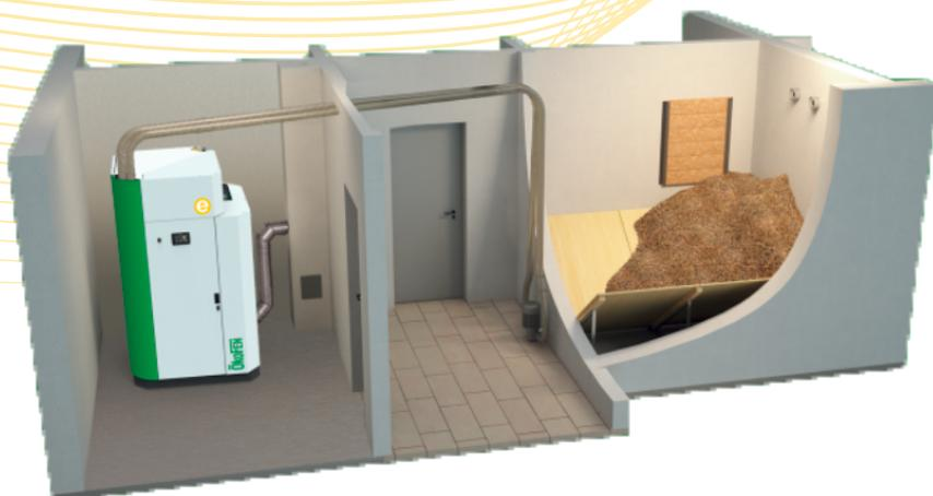
PE Smart\_e con aspirazione sottovuoto e magazzino del pellet
